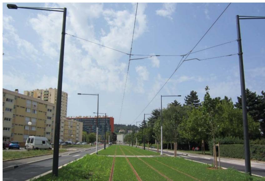
Figure 19 : Exemple poteaux latéraux avec suspension sous transversal (Tramway de Dijon)
